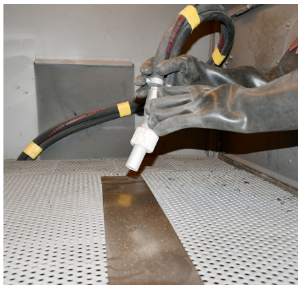
2. Stralen met korrund in het Werk
