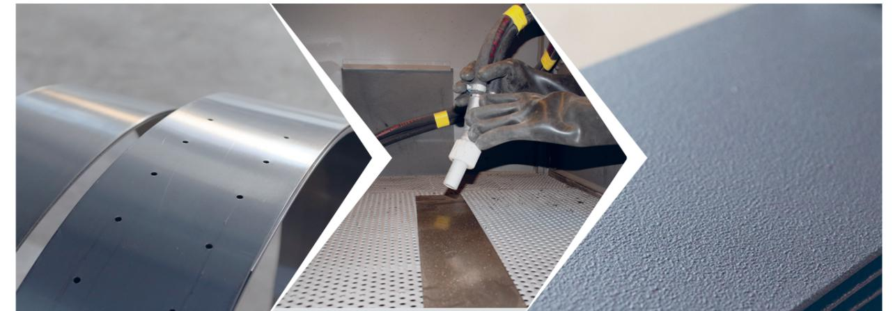
1. re-plate vorgelocht 2. Strahlen mit Korund 3. Korrosionsschutz mit SikaCor EG1
