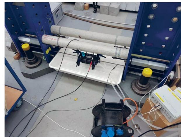
1. Empa Versuch Spannungsrissskorrosion
