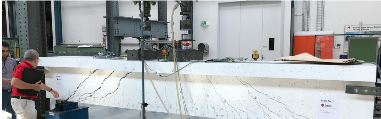
1. T-Träger: Nach Belastungsversuch sind die inneren Schubbügel gerissen. Klaffende Risse sind entstanden.
