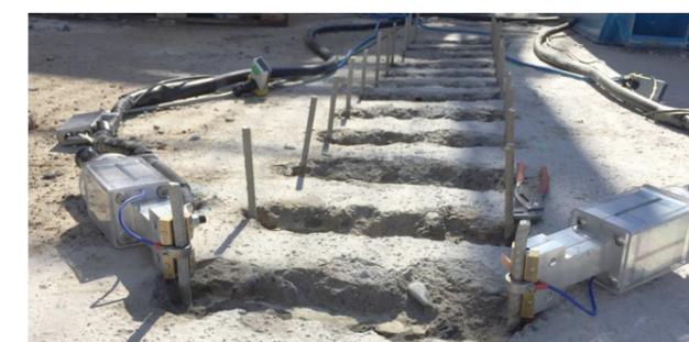
3. Aktivierung durch Widerstandsheizung mit Stromzufuhr
