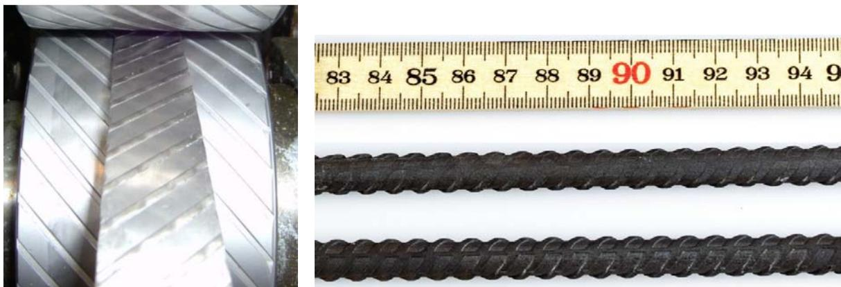
Fig. 27 Prototypen einer memory-steel Lamelle mit Rippung (links) und gerippter Stab (rechts)
