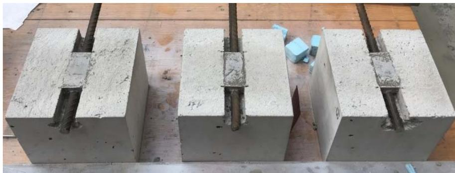
Fig. 16 Probekörper für die Ausreißversuche mit eingeschlitztem re-bar im Grout Resultate
