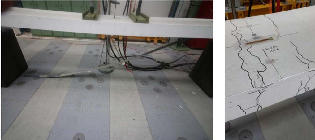
Fig. 26 Versagensmodus: Abplatzen der CFK Lamelle (links) und Betonstauchen der oberen Druckzone bei einer re-plate Verstärkung (rechts) [18]
