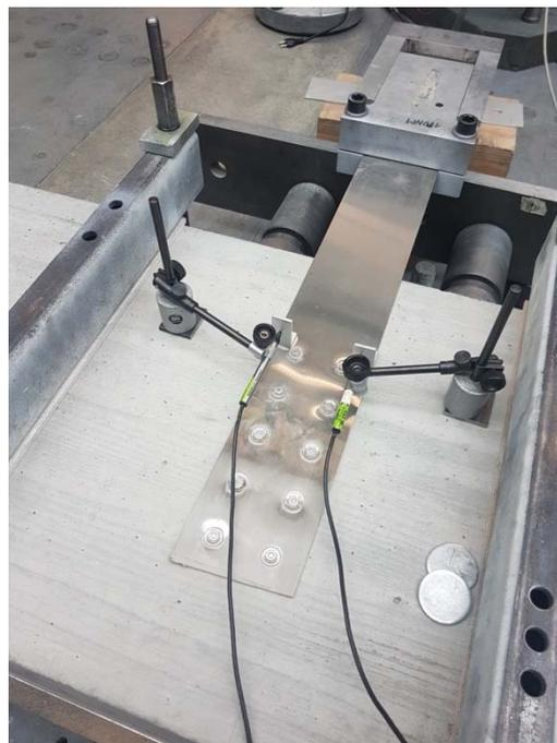
**Fig. 13 Abzugsversuch mit Messung des Schlupfes**
