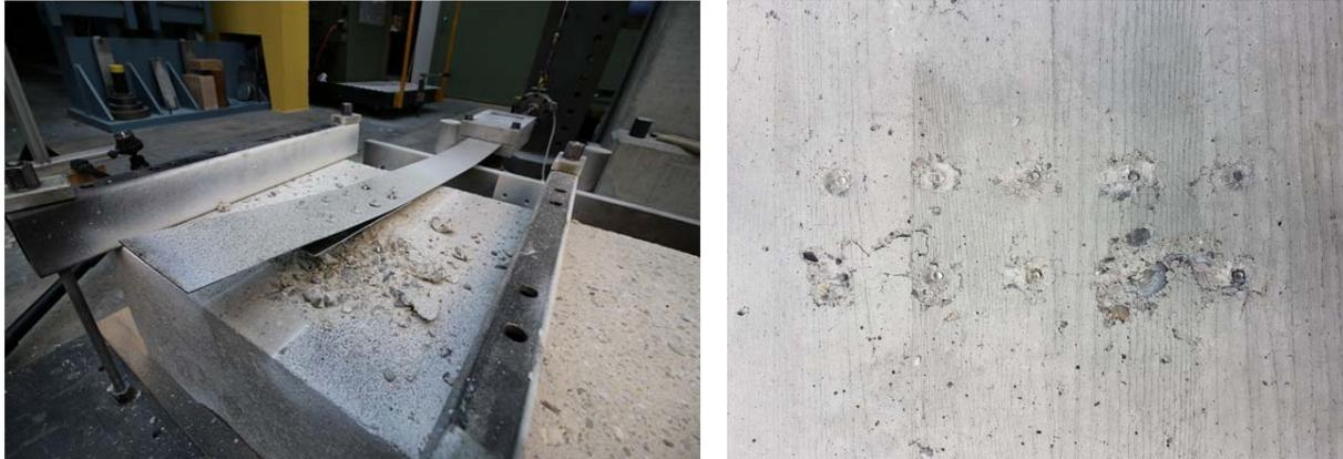
Fig. 15 Ausreißen des Betonkegels bei NPH2 (links) und Abscheren der Nägel bei X-CR (rechts)
