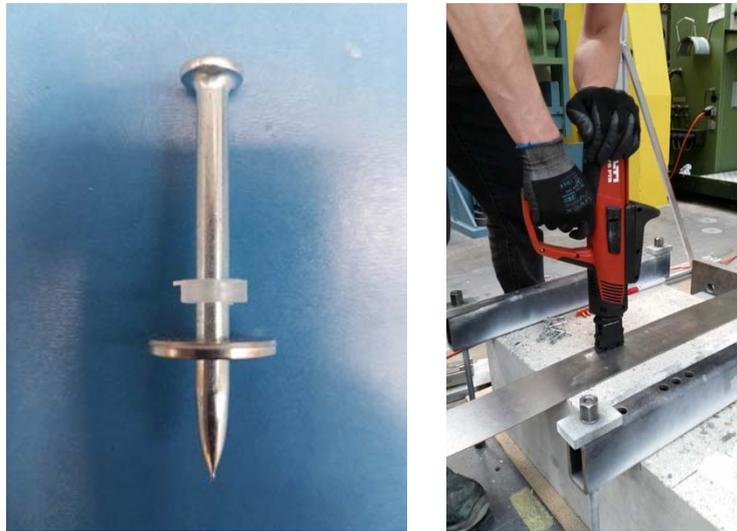
**Fig. 12 X-CR 48 P8 S15 (links) und Direktbefestigung der Lamelle an den Beton (rechts)**
