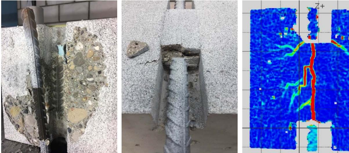
Fig. 17 Bruchbilder (links und Mitte) und Erfassung der Rissentwicklung mittels Bildkorrelation (rechts)
