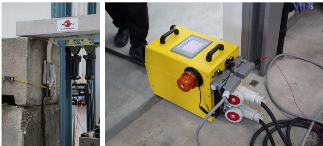
Fig. 20 Aktivieren durch Stromzufuhr (Widerstandsheizern) [18]
