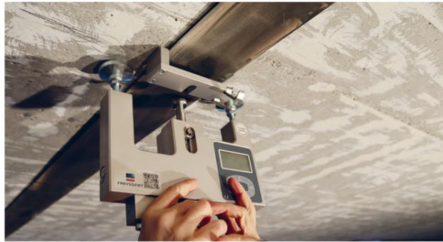
1. Kontrolle der Vorspannkraft mit Prüfgerät
