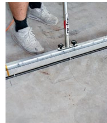
4 Activation de re-bar au moyen du chauffage infrarouge re-IR 1500
