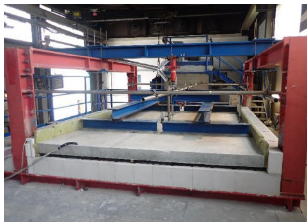
Bild A3.18 Blick auf die feuerabgewandte Seite (125. Prüfminute)
