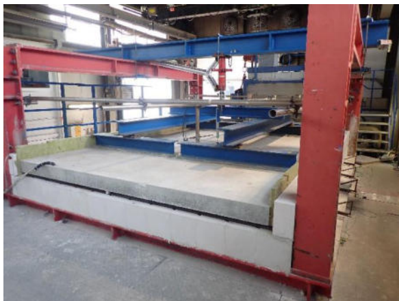
Bild A3.11 Blick auf die feuerabgewandte Seite mit der Lasteinleitung
