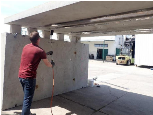
Bild A3.3 Aktivierung der Lamellen
