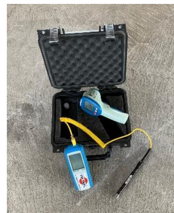
Temperatursensor mit Kontaktstift
