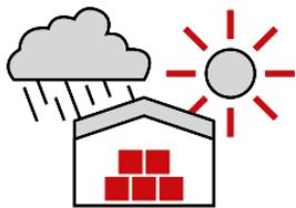
Die Materialien müssen in ungeöffneter Originalverpackung trocken und kühl gelagert werden. Bezüglich der minimalen und maximalen Lagertemperatur sind die jeweiligen Angaben in den Produktdatenblättern zu beachten. **Produkte vor direkter Sonneneinstrahlung schützen!** re-plate darf nur in der Originalverpackung oder mit einem sonstigen adäquaten Schutz vor mechanischen Beschädigungen oder Hitzeeinwirkung transportiert werden.
